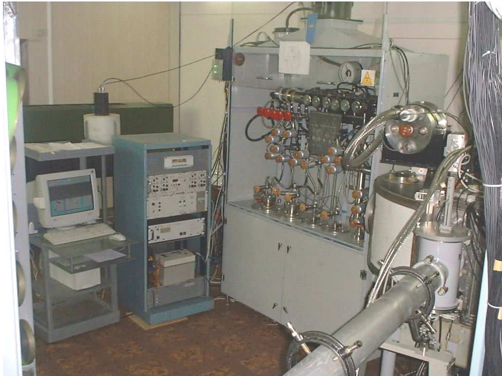
Рис.33. Внешний вид газового комплекса тритиевой мишени установки АКУЛИНА.
