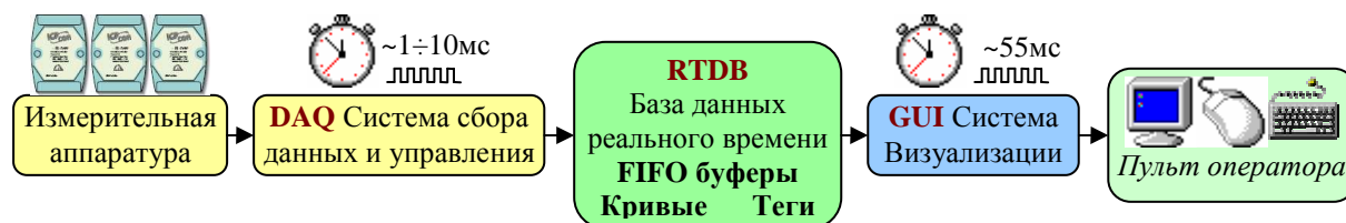
Рис.9. Модель взаимодействия потоков визуализации и управления в пакете CRW-DAQ.
